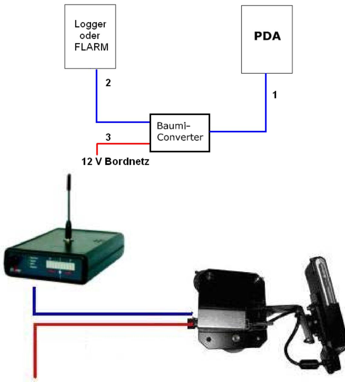
Der Baumi-Converter wird vom Bordnetz mit 12 Volt versorgt (Kabel #3). Die Versorgungsspannung von 12 Volt für FLARM wird beim Baumi-Converter durchgeschliffen (Kabel #2).
