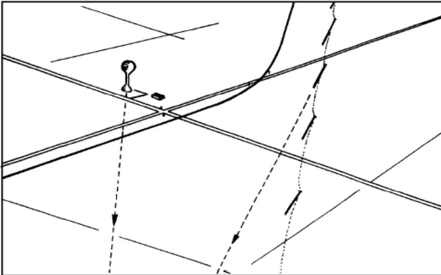
Die Linien der vertikalen Objekte im Wendepunktfoto werden nach unten verlängert. Die Position des Segelflugzeugs befindet sich im Schnittpunkt dieser verlängerten Linien
